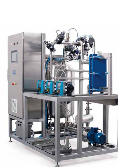
Sistema de Limpeza CIP
