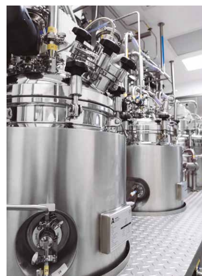
Produção de vacinas - etapa downstream do processo
