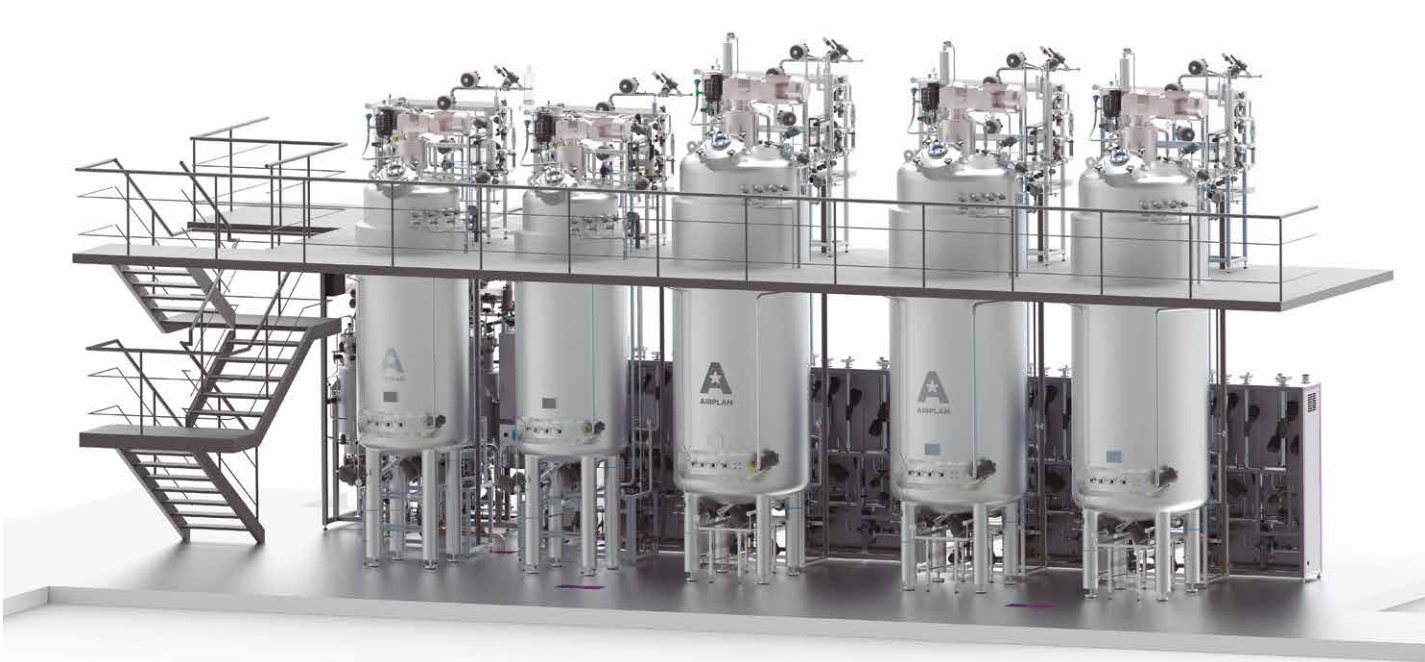
Bioréacteurs pour les deuxième et troisième phases de fermentation dans un processus de vaccins
